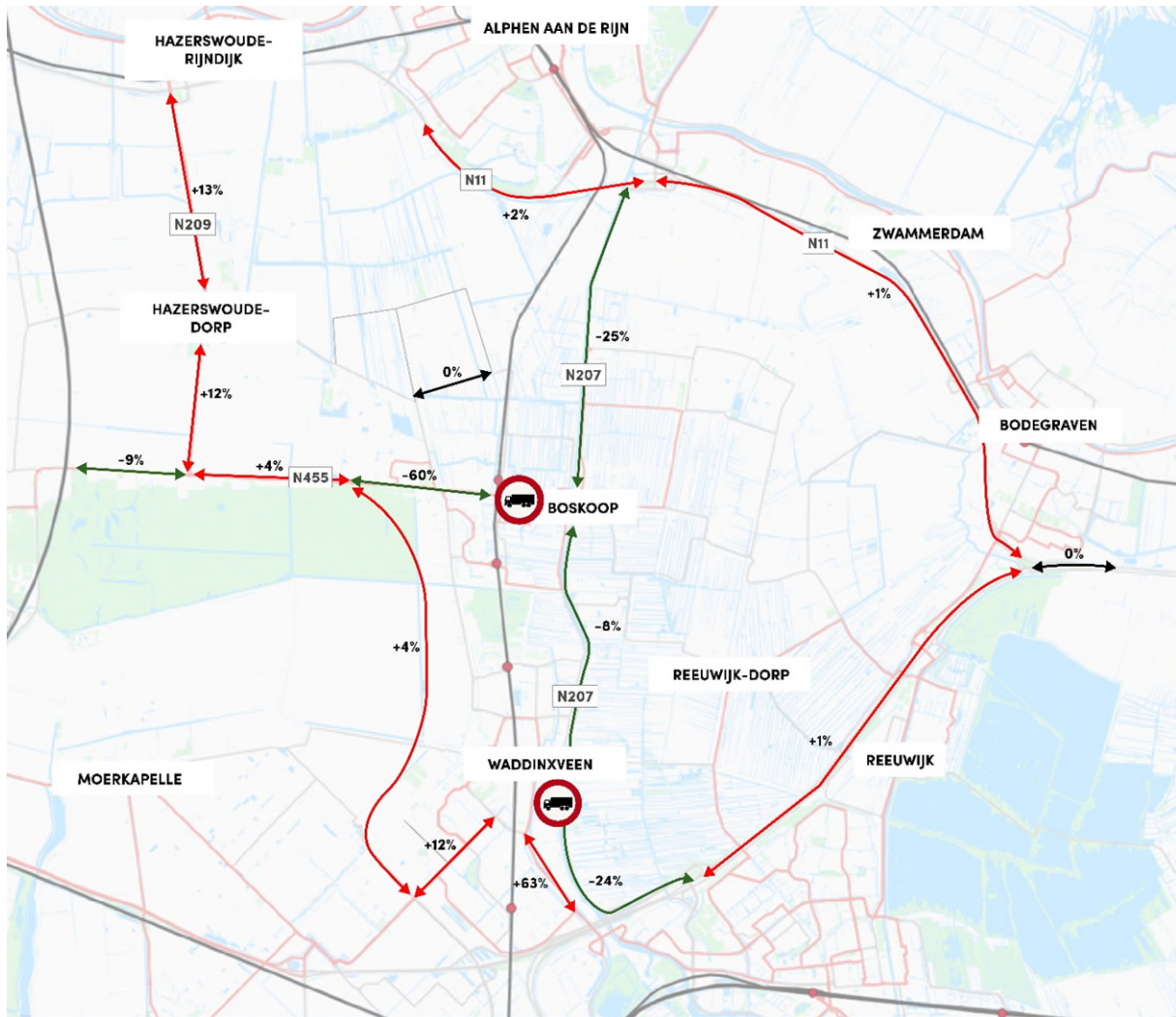
Figuur 15. Procentuele verschillen (vrachtwagens per etmaal) referentie incl. vrachtwagenverbod t.o.v. referentie 2030.
